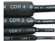
TUBE THERMO 4:1 NOIR À PAROI DOUBLE TRÈS ÉPAISSE RÉISTANT AU DIESEL AVEC ADHÉSIF 8381-43 - 6.60mm 8382-43 - 8.64 mm 8383-43 - 11.68 mm 8384-43 - 19.30 mm
