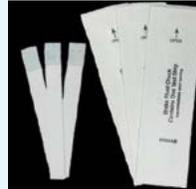
• Les bandelettes de test diagnostique de liquide évaluent l'état du liquide et identifient quand un liquide doit être changé.
